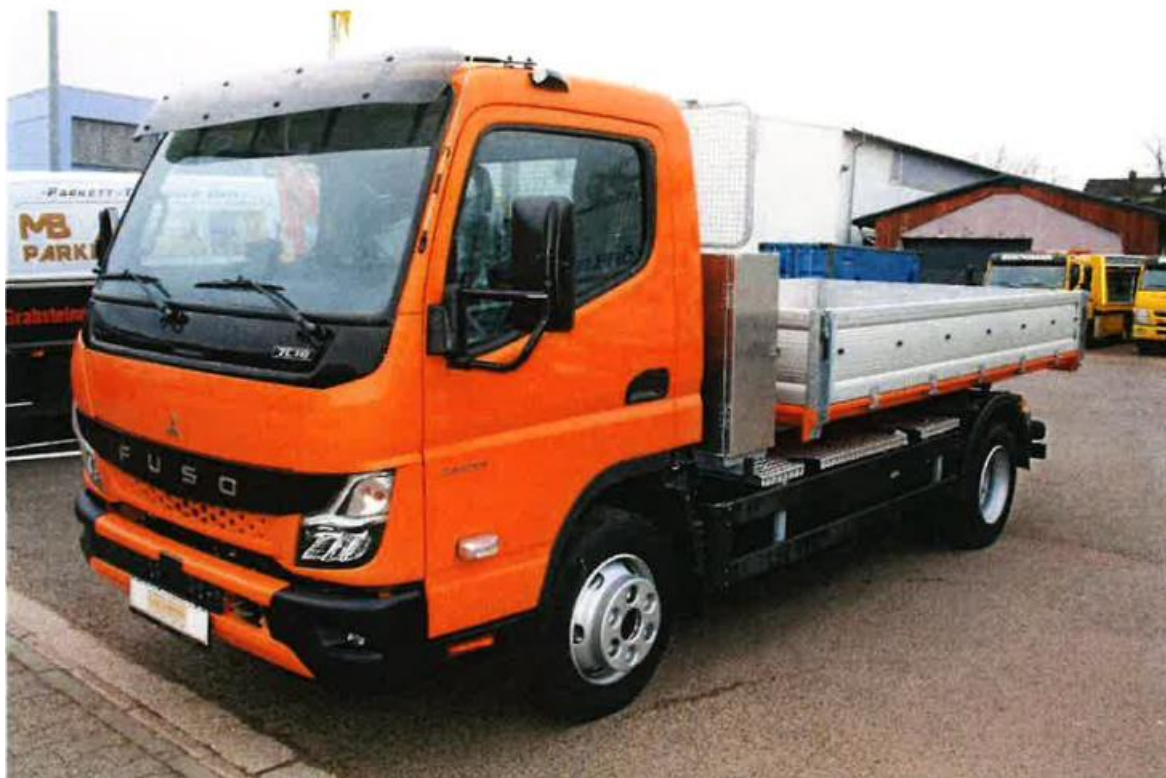
Abbildung 1 FUSO Canter 7C18 mit Abrollsystem-Aufbau (Abrollkipper) des Herstellers Maytec Fahrzeugbau GmbH
