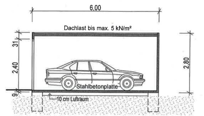
Streifenfundamente auf frostfreie Tiefe und standsicheren Boden herstellen. Dieser Plan genügt nicht für die Erstellung der Fundamente!!! Fundamentplan anfordern!
